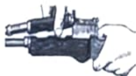
Рис. 43. Отделение затворной рамы с затвором
